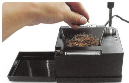
Zvednutím páky otevřete komoru pro tabák. Nasypete tabák. Tabákovou komoru nepřepĺňujte.
